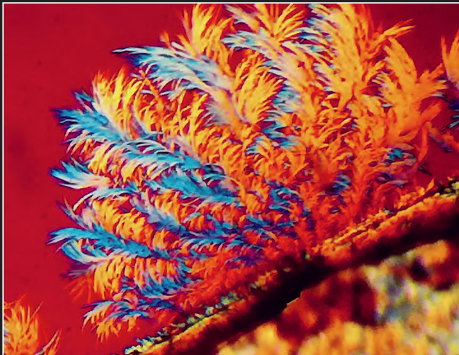
Ha oldatba viszünk sokat, vitaminokat, gyógyszereket vagy bármilyen vegyszert, majd finomrétegben szétkenjük a tárgylemezen, akkor azt kiszárítva és polarizációs fényben megtekintve garantáltan vizuális csodában részesülhetünk. A képen egy gyógyszer hatóanyagai kristályosodtak ki.
