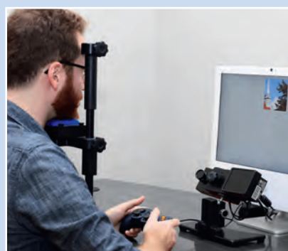
A vizsgálatban használt szemmozgáskövető készülék. A kísérleti résztvevő állát az erre kialakított keretbe illeszti, az asztalon elhelyezett kamera pedig rögzíti a szem mozgásait.
