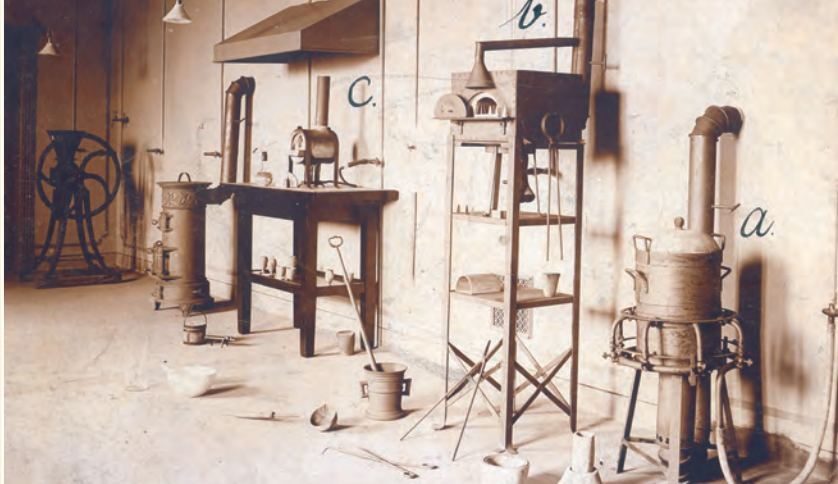
Az agyagok tűzállóságának vizsgálatára szolgáló kemencék a laboratórium alagsorában
